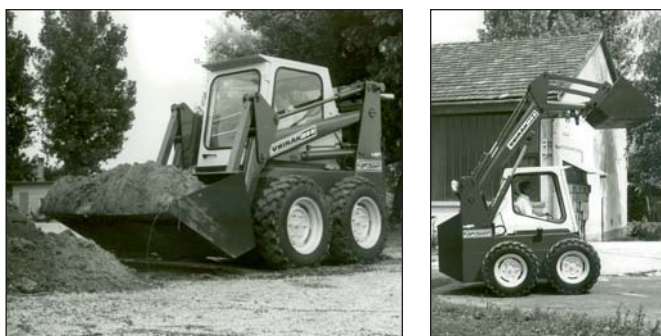
2. ábra: Az Unirak 800-as rakodógép földmunka közben
